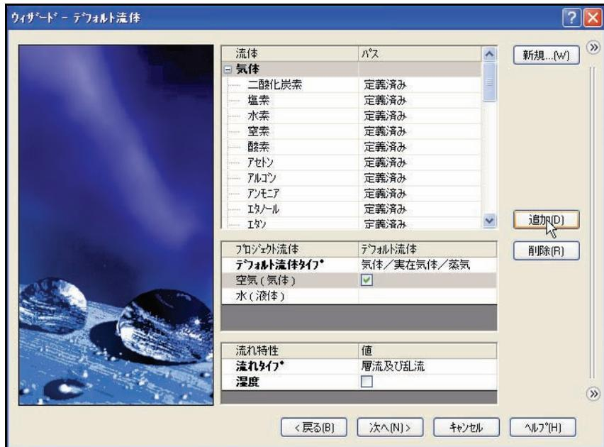
**注記** : SolidWorks Flow Simulation には、エンジニアリング データベースと呼ばれる、多数の液体や気体のデータベース ライブラリがあります。このデータベースを使用し、独自の材料を作成することも可能です。
