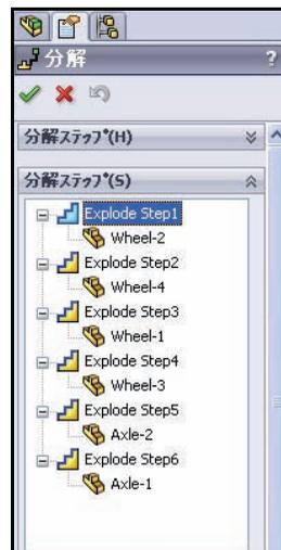
それぞれの**分解ステップ** (Explode Step) を分解ステップ (Explode Step) ボックスで展開します。結果を表示します。
