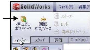
**押し出しボス/ベース** (Extruded Boss/Base)
