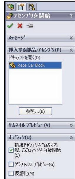
**注記：** アセンブリに最初に追加された構成部品は、デフォルトで固定されます。固定された構成部品は、非固定にしない限り、動かせなくなります。
