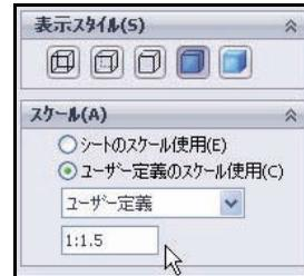
**ユーザー定義のスケール使用** (Use custom scale) ボックスを選択します。
