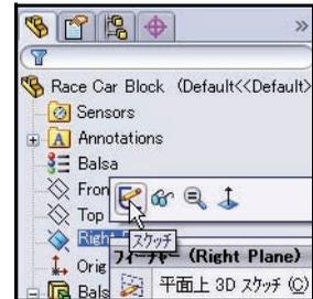
スケッチ (Sketch)
