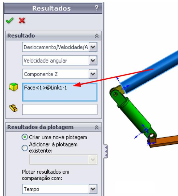
A plotagem acima mostra a variação da velocidade angular do centro de massa de Link1 em função do tempo.
