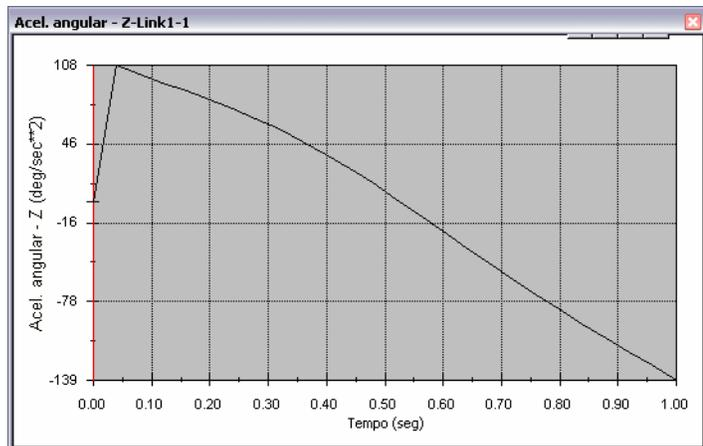
**Nota:** A direção rotacional positiva pode ser determinada usando a regra da mão direita. Aponte o polegar da mão direita na direção do eixo (em nosso caso o eixo Z). Os dedos mostrarão a direção positiva do componente Z da rotação.
