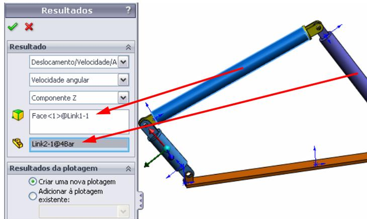
**Nota:** A tríade no componente Link2 indica o sistema de coordenadas local de saída. Ao contrário do sistema de coordenadas global que é fixo, o sistema de coordenadas local pode girar.. Em nosso caso, o sistema de coordenadas local selecionado irá girar porque o componente Link2 gira quando o mecanismo se move.
