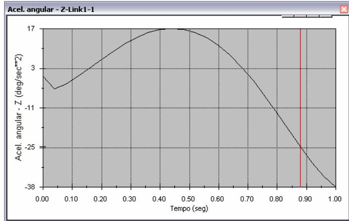
De maneira similar, crie as plotagens do **Componente Z** da velocidade angular e da aceleração angular no centro de massa de Link2 e Link3.
