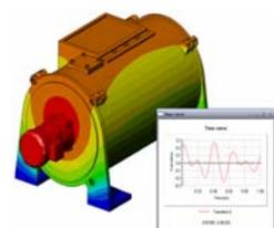
O Flow Simulation permite ao usuário analisar o comportamento e o efeito de fluidos em movimento no interior ou em volta de peças e montagens. Também é considerada a transferência de calor em fluidos e em sólidos. Os efeitos de pressão e temperatura podem ser subsequentemente transferidos para os estudos do SolidWorks Simulation para prosseguir com a análise de tensão.
