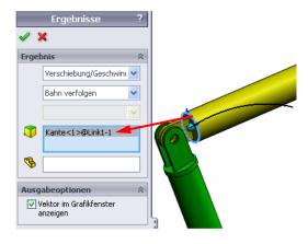
**Hinweis:** Die resultierende Spurkurve wird standardmäßig mit Bezug auf den fixierten Boden angezeigt. Um die Spurkurve in Bezug auf eine andere bewegliche Komponente darzustellen, muss diese Referenzkomponente im gleichen Auswahlfeld als zweite Komponente ausgewählt werden.
