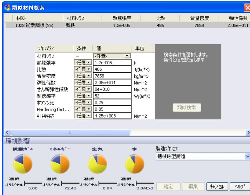
**類似材料検索 (Find Similar Material)** メニューには複数の異なるオプションがあります。図のように、Thermal Expansion 以下、複数の材料特性のリストが表示されます。
