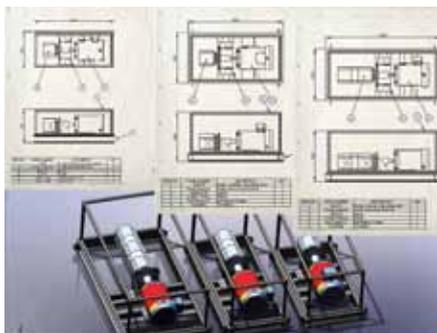
DriveWorksXpress erfasst wichtige Konstruktionsregeln in SolidWorks, erstellt automatisch Baugruppen, Zeichnungen und Modelle und sorgt so für eine Automatisierung wiederkehrender Konstruktionsaufgaben.
