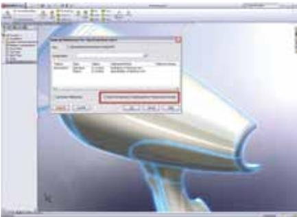
SolidWorks ermöglicht in ein und derselben Modellierungsumgebung die Erstellung komplexer Volumenkörpergeometrien, wie Austragungen und Verschmelzungen oder Freiform-Oberflächen mit durchgehender Krümmung.
